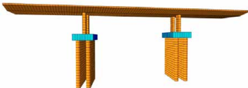
Obr. 4 Model mosta so základovými pätkami a pilótami
