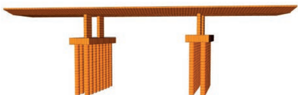
Obr. 4 – Model mosta so základovými pätkami a pilótami
